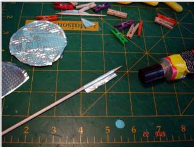
A l'aide du réglet et du stylo, tracez sur le métal un petit rectangle d'environ 1 cm à 1,5 cm de largeur sur 2 à 3 cm de hauteur.
